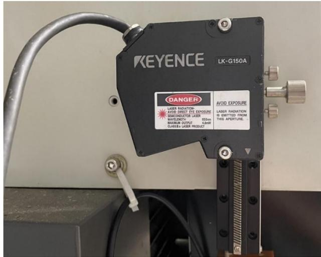
図 2.3.2 レーザー変位計
