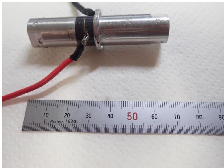
図 2.2 ランジュバン型振動子
