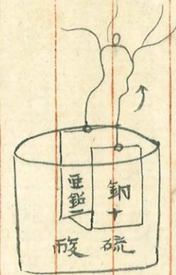
銅板ヨリ線端ヲ陽極亜鉛ヨリ突タル陰極ト名ク銅ハ導体ナリ且硫酸ニ接スル故陽電ヲ取ルヤ硫酸ハ酸美ナ故ニ陽電ヲ取ルヤ
